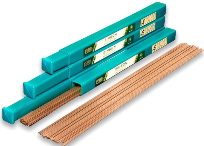
آلیاژهای لحیم کاری سخت، خانواده کادمیوم دار، دارای نقطه ذوب پایین، دامنه ذوب کوتاه، و سیالیت بالا میباشند، همچنین خواص مکانیکی بالا و مقاومت به خوردگی دربرابر گاز کلر و محیط های حاوی بخ-ار و نیز سولفور از دیگر خصوصیات آلیاژهای این گروه می باشد. این سیم جوش ها می باشند حتی همراه با فلاکس مناسب مصرف شوند تا هنگام جوشکاری سیالیت و نفوذ لازم ایجاد شود.
